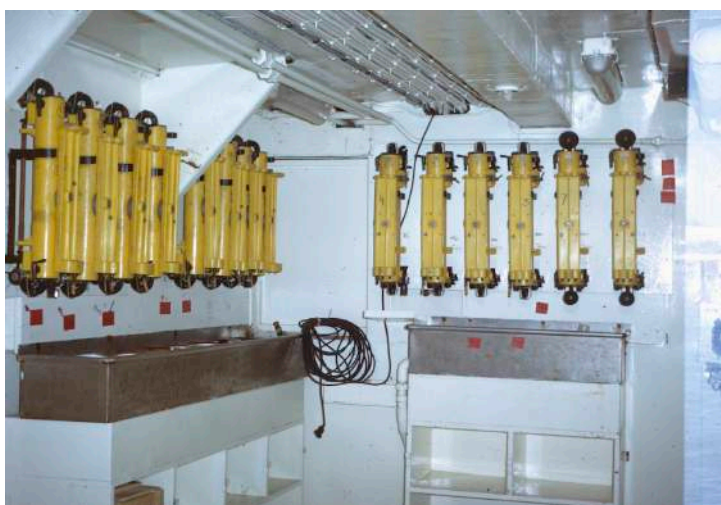
14 Râtelier de bouteilles d'hydrologie NIO en PVC remplaçant, vers les années 1960, les bouteilles à renversement métalliques.
