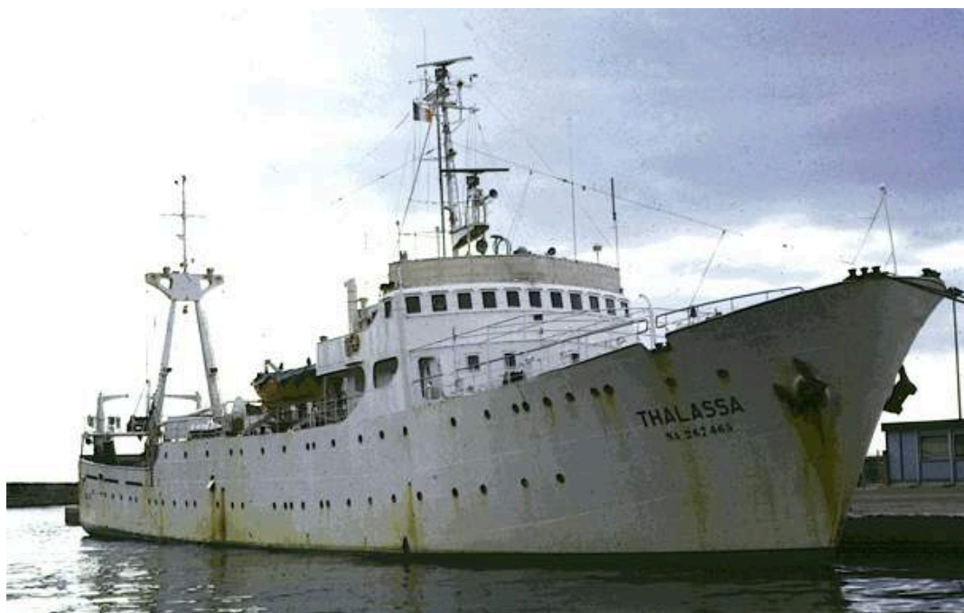
11 La Thalassa, navire de recherche de l'ISTPM ayant testé en France le chalutage par l'arrière
